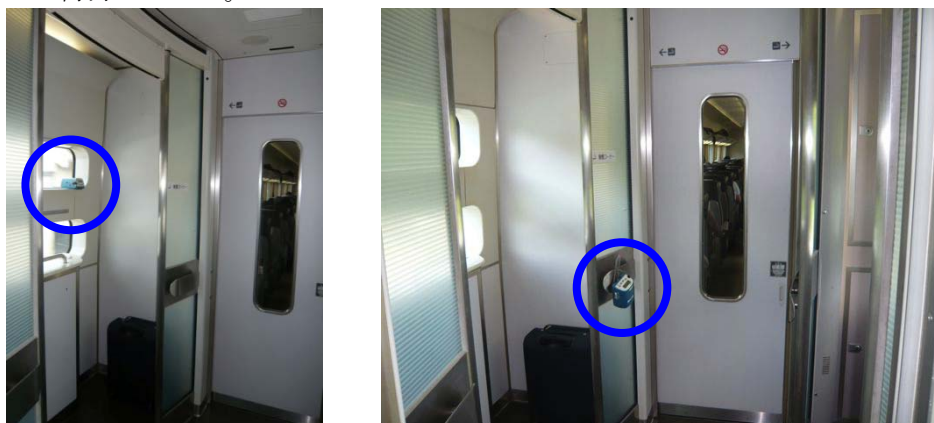
図1. 喫煙コーナー(左、8:58～9:58)、通路(右、9:58～10:53)の粉じん濃度測定 (青○部分に粉じん計)
