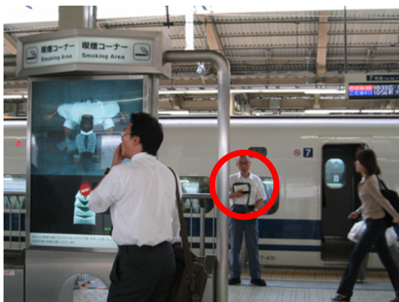
図1. 新幹線、禁煙車両の前に並んだ場合の受動喫煙曝露濃度（赤い丸は粉じん計を示す）
